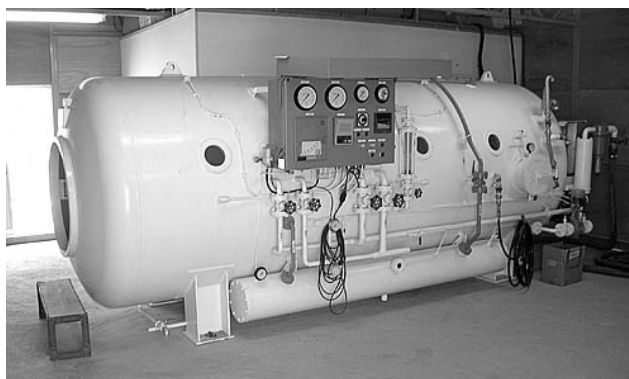
図-14.3 ホスピタル・ロック 出典：大本組 ニューマチック工法仮設備
